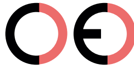
Falsche CE-Kennzeichnung (zu großer Zwischenraum)
